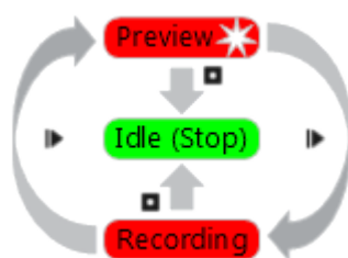
Рис. 5.1: Диаграмма режимов съемки (цвета соответствуют цветам светодиодного индикатора сканера)
