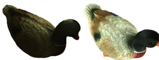
Рис. 5.15: Влияние внешнего освещения на результаты съемки
