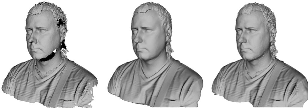
Abbildung 81: Mensch-Modelle als Ergebnis verschiedener Algorithmen: *Schelle Fusionierung* (links), *Weiche Fusionierung* (Mitte) und *Scharfe Fusionierung* (rechts).
