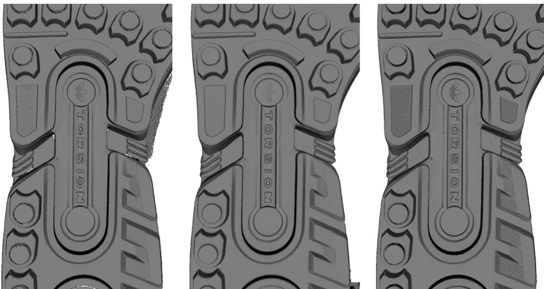
Abbildung 82: Modelle einer Schuhsohle als Ergebnis verschiedener Algorithmen: *Schelle Fusionierung* (links), *Weiche Fusionierung* (Mitte) und *Scharfe Fusionierung* (rechts).
