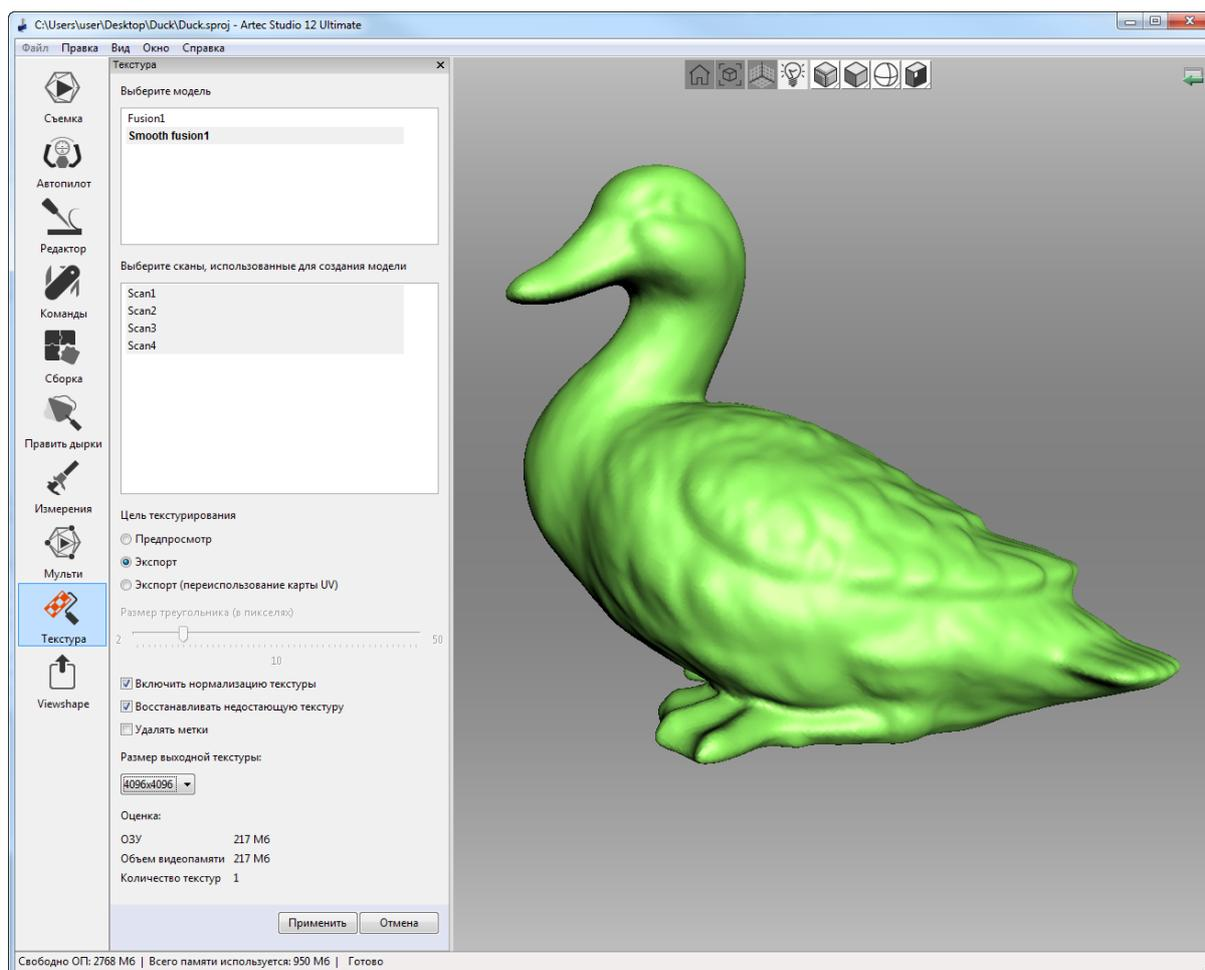
Рис. 9.38: Выбор метода текстурирования и настройка его параметров
