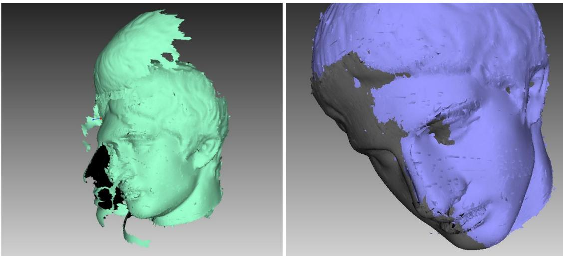
Рис. 9.23: Ошибки глобальной регистрации: некорректные настройки слева и разрыв между сканами справа.
