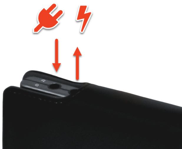
Рис. 3.8: Порты батареи слева направо: Input (вход), Output (выход).
