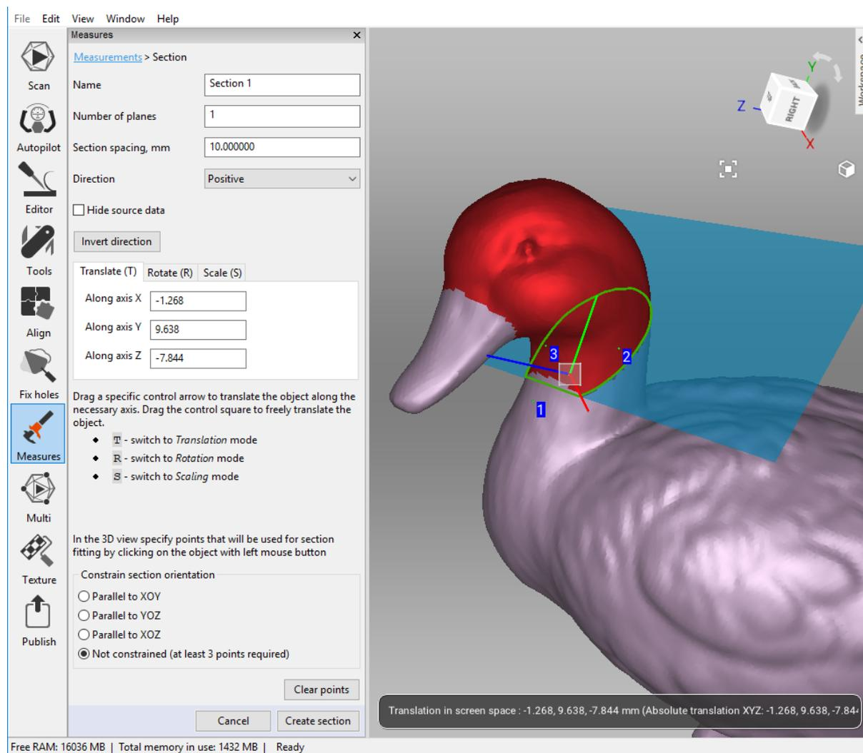
Рис. 10.9: Ориентация нового сечения в режиме *Перенос*.
