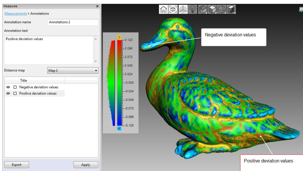
Рис. 10.13: Аннотация на модели с картой расстояний
