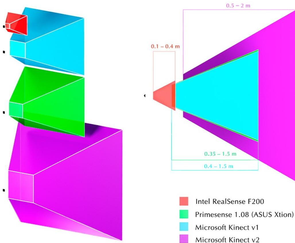
Рис. 3.5: Рабочие диапазоны и поля зрения сторонних 3D-сенсоров
