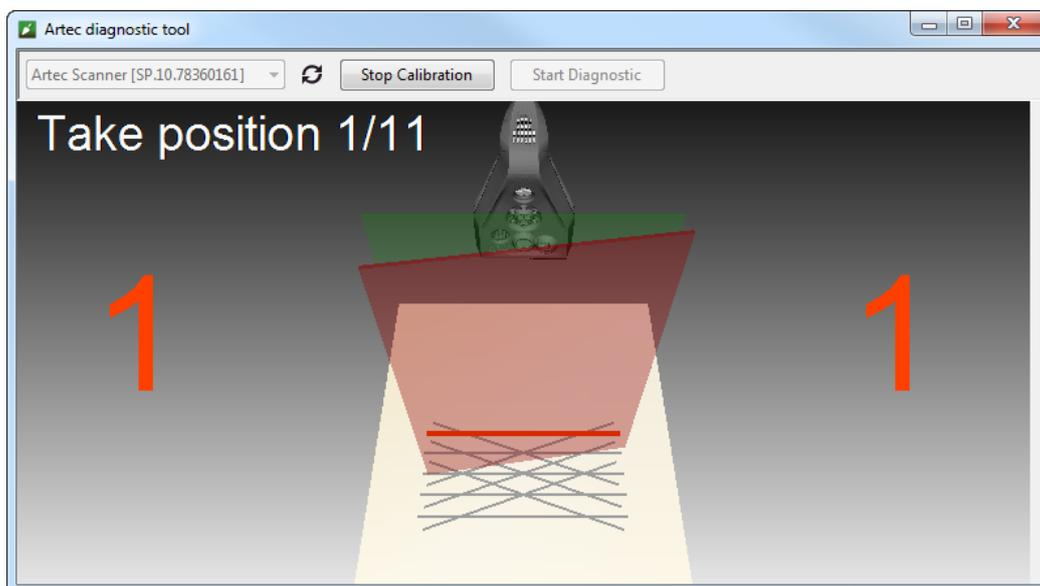
Рис. 12.11: Перемещение калибровочного стенда в положение № 1
