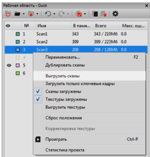
Рис. 6.3: Выборочная выгрузка сканов
