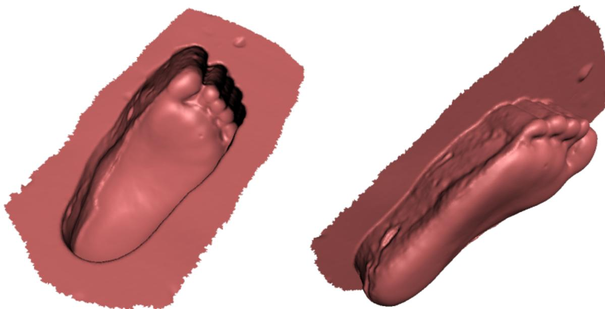
Рис. 9.49: Применение инвертирования нормалей: получение модели ступни (справа) из ее слепка (справа)
