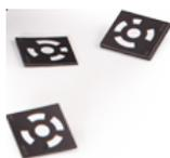
Рис. 5.11: Кодированные метки
