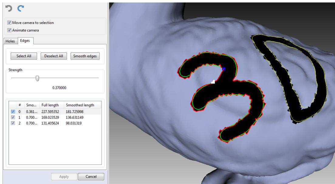
Рис. 9.34: Выделение границ для сглаживания краев
